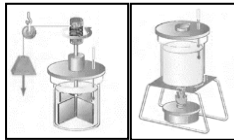
Gambar 4.12 Perubahan suhu pada sistem dapat dicapai dengan (a) memberi kerja pada sistem (b) menambah panas pada sistem (Young at all , 2008).
