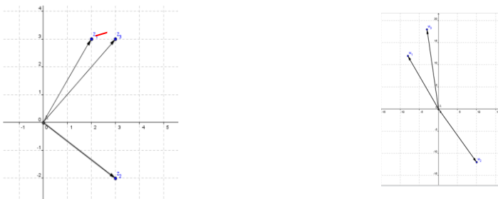
Gambar 8. Pemetaan dari Bidang-Z ke Bidang-W
